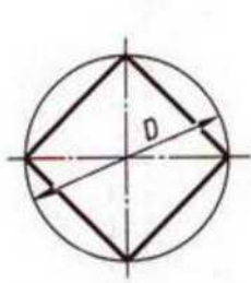
Разделить окружность на 4 и 8 равных частей
